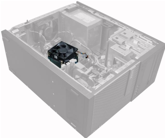
3. Pressione o grampo de plástico para soltar e desligar o cabo do dissipador de calor da placa de sistema.
