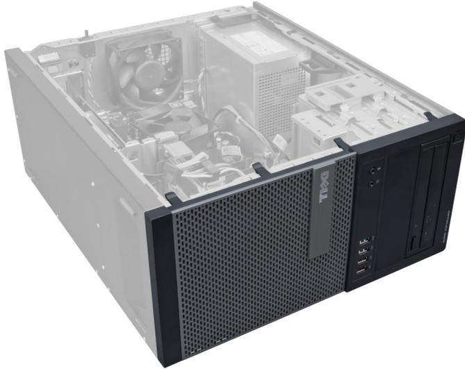
3. Com cuidado, levante do chassis os grampos de fixação do painel frontal localizados na extremidade lateral do painel frontal.
