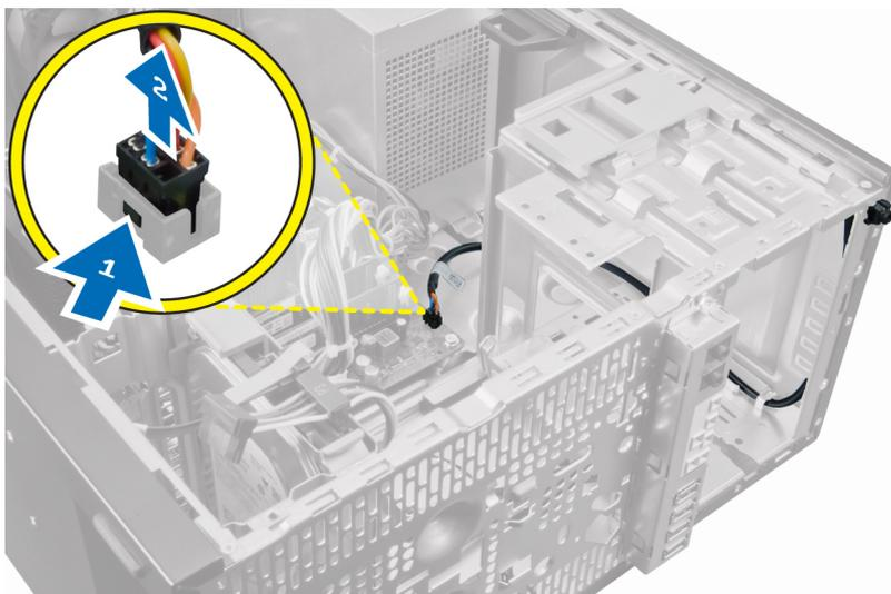
4. Solte o cabo do interruptor de alimentação dos grampos no chassis.
