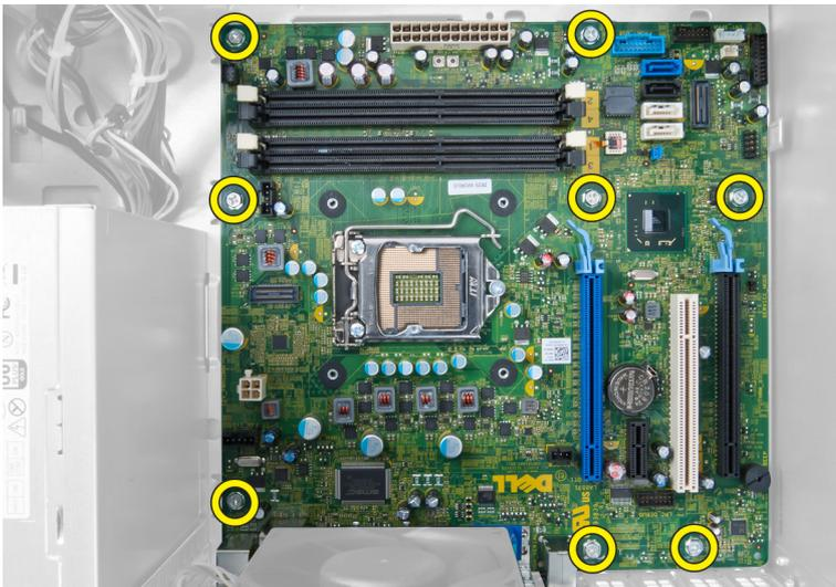
5. Faça deslizar a placa de sistema em direcção à parte frontal do computador.
