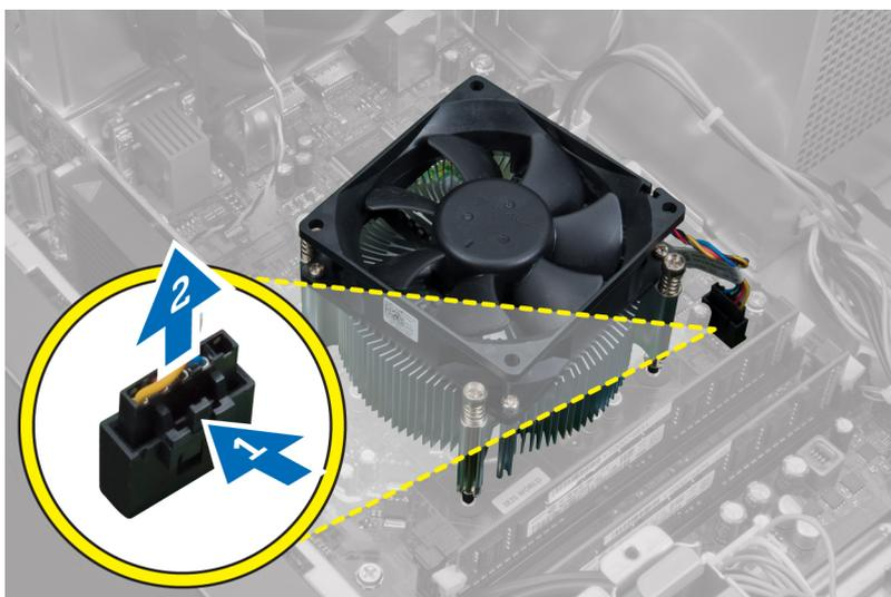
4. Utilize uma chave de fendas Phillips para desapertar os parafusos integrados na diagonal e retire o dissipador de calor do computador.
