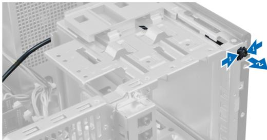
6. Faça deslizar o interruptor de alimentação juntamente com o respectivo cabo para fora através da parte frontal do computador.
