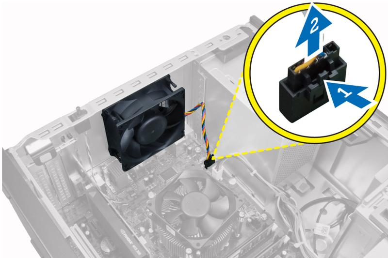
4. Levante a ventoinha do sistema e retire-a dos quatro ilhoses que fixam a ventoinha à parte posterior do computador.
