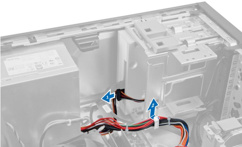
4. Desligue o cabo de alimentação da(s) unidade(s) óptica(s) e solte-o do grampo. Desligue o cabo de 24 pinos da placa de sistema.
