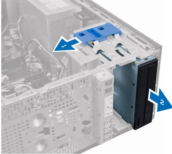
6. Repita os passos 4 e 5 para retirar a segunda unidade óptica (se existir).
