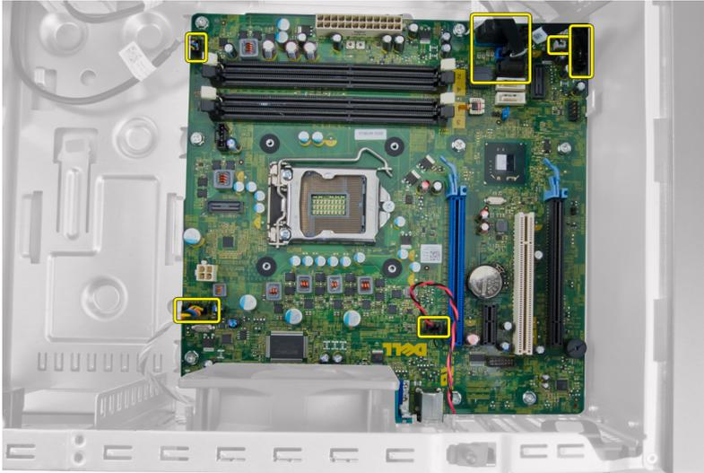
4. Retire os parafusos que fixam a placa de sistema ao computador.
