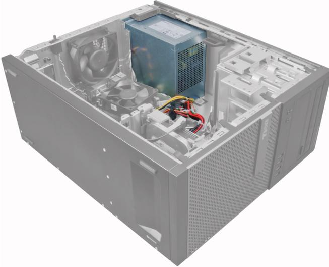
3. Solte e desligue o cabo de alimentação da(s) unidade(s) óptica(s).
