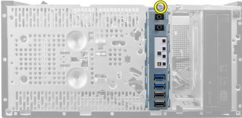
7. Faça deslizar o painel de E/S para o lado esquerdo para soltá-lo e puxe o painel de E/S juntamente com o cabo para fora do computador.
