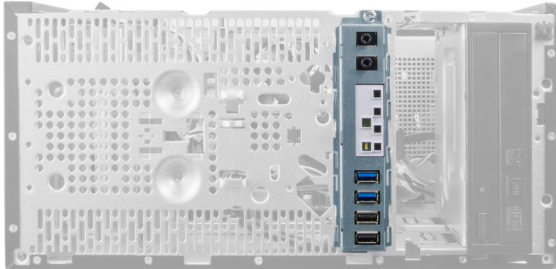
4. Desligue o cabo do painel de E/S e FlyWire da placa do sistema.
