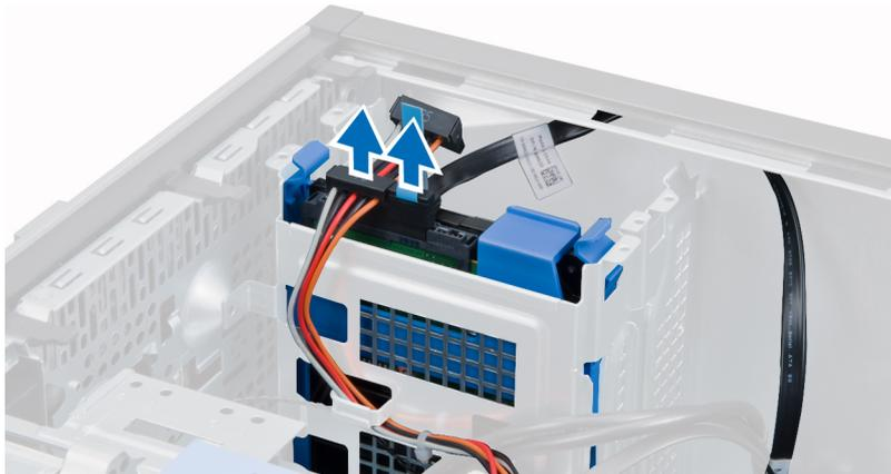
4. Pressione para dentro ambas as patilhas azuis de fixação do suporte e retire o suporte da unidade de disco rígido do compartimento.
