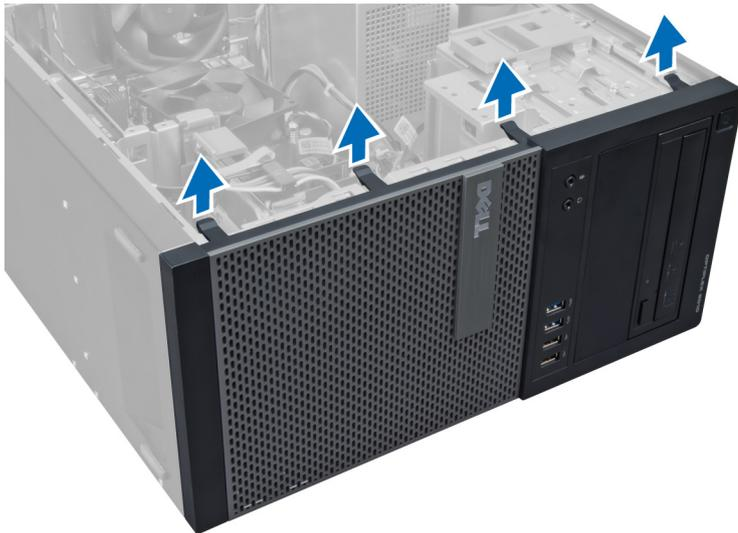
4. Rode e retire o painel frontal do computador para soltar do chassis os ganchos existentes na extremidade oposta do painel.
