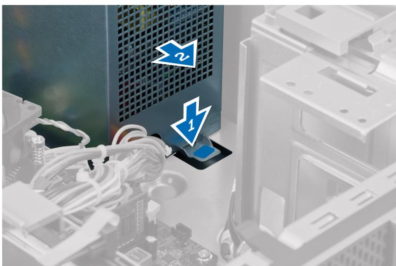
8. Levante a fonte de alimentação e retire-a do computador.
