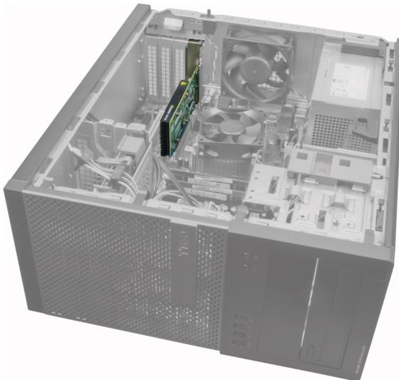
3. Pressione o trinco de fixação da placa no interior e puxe o trinco para fora no outro lado.
