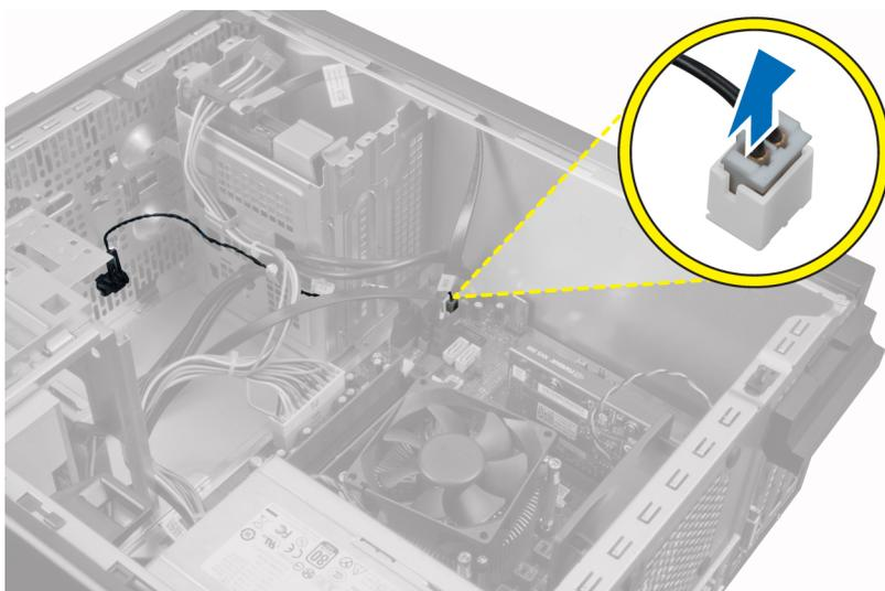
4. Solte o cabo do sensor térmico do grampo no chassis.
