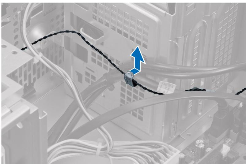
5. Pressione cuidadosamente as patilhas de ambos os lados para soltar e remover o sensor térmico do chassis.
